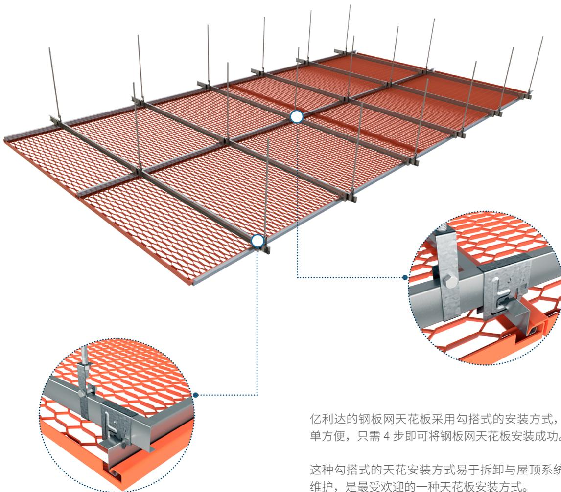
亿利达的钢板网天花板采用勾搭式的安装方式，简单方便，只需 4 步即可将钢板网天花板安装成功。
